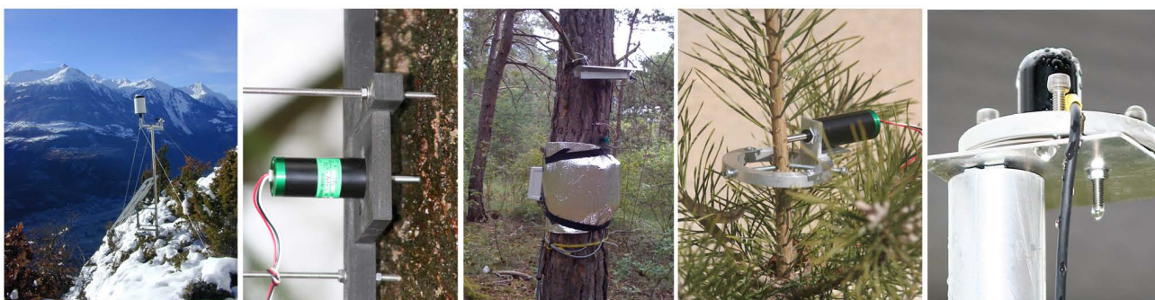
Abb. 2 Meteostation oberhalb von Gampel, VS. Punktdendrometer zur Messung von Stammradiusänderungen im Mikrometerbereich, Saftfluss-Messungen sowie einen Stamm- CO_2 -Sensor an einer Föhre im Pflanzwald, VS. Weiteres Dendrometer für kleine Stämme und Zweige. Nahaufnahme eines Lichtsensors auf einem Meteomast.
